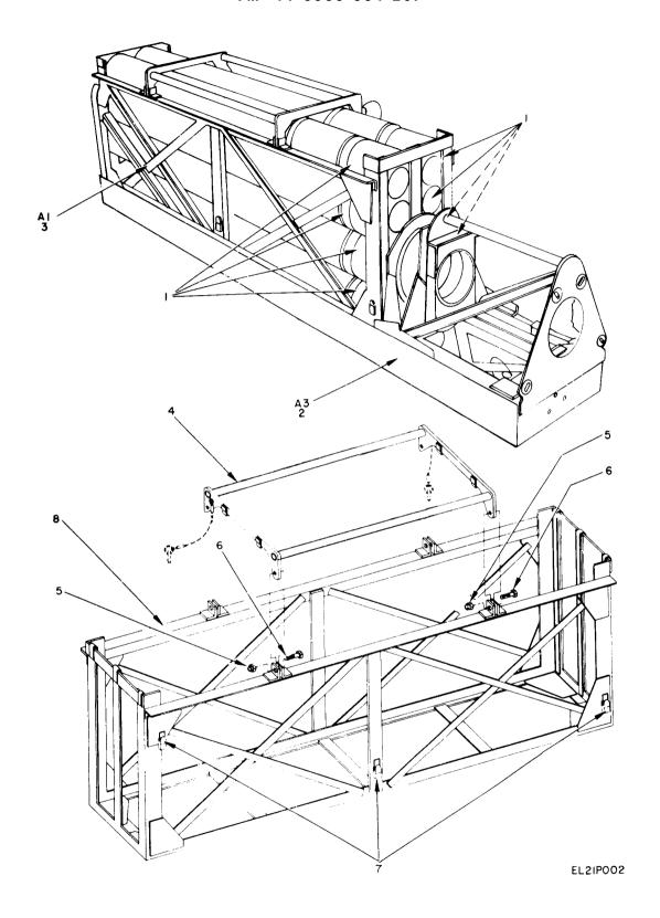
Figure 2. Mast AB-621/G, Carrier.
